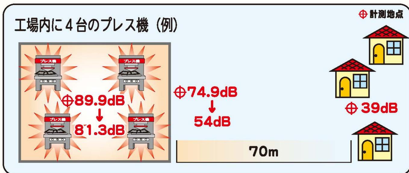
**プラス プレス機から発生する岩盤振動を抑制する為、免震部材を使用する基礎工事を開発中!**
